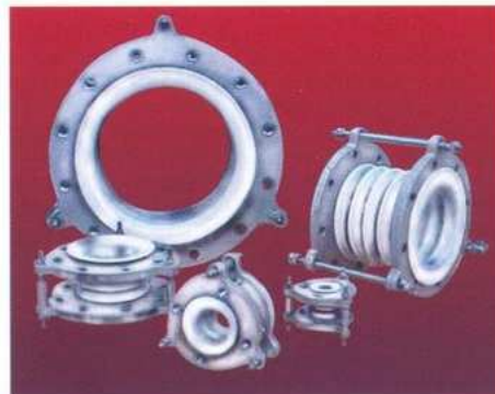
JUNTAS DE EXPANSÃO EM PTFE. São projetadas para absorver movimentos axiais, laterais, angulares, combinações destes e vibração. São particularmente indicados para condução de fluidos corrosivos.
