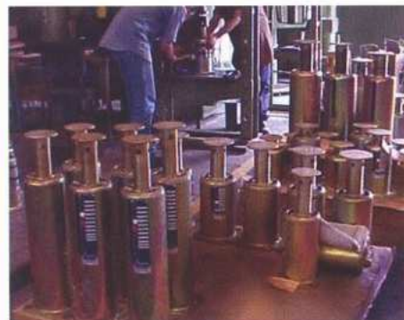
SUPORTE DE MOLA. Os suportes de mola de carga variável e constante são projetados para suportar pesos de tubulações ou equipamentos sujeitos a movimentos verticais resultantes de dilatação térmica. Fornecemos acessórios também, tais como braçadeiras, tirantes, esticadores, olhais, etc.
