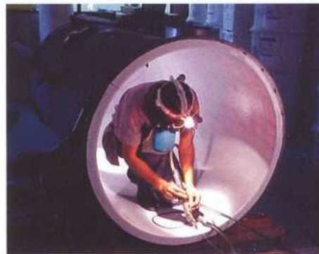
TUBOS E CONEXÕES, VASOS E TANQUES REVESTIDOS COM PTFE. A linha de produtos de aço e fibra revestidos com PTFE, solucionam os problemas de seleção para condução de fluidos corrosivos.
